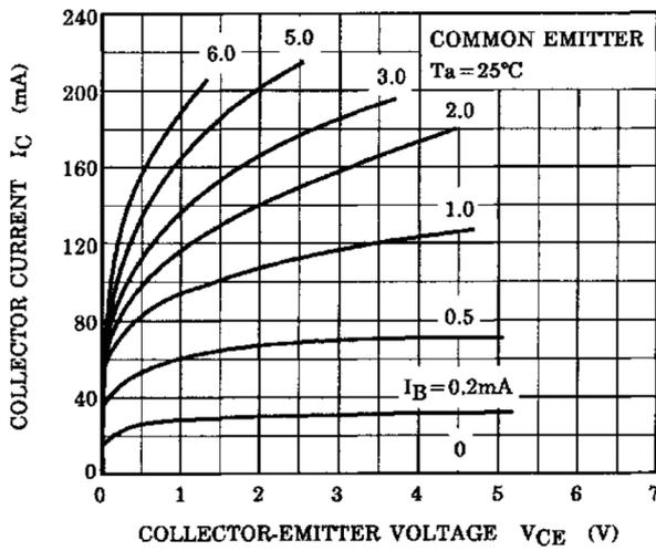
Fig. 8.1  $I_C - V_{CE}$
