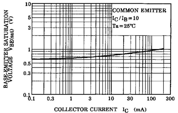
Fig. 8.4  $V_{BE(sat)} - I_C$
