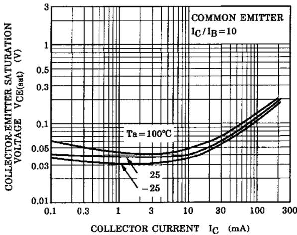
Fig. 8.3  $V_{CE(sat)} - I_C$
