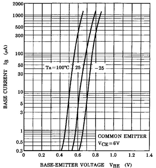
Fig. 8.6  $I_B - V_{BE}$
