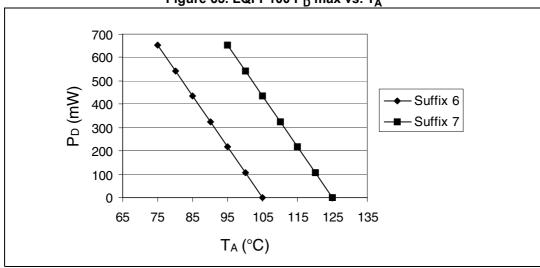
Figure 65. LQFP100 P<sub>D</sub> max vs. T<sub>A</sub>
