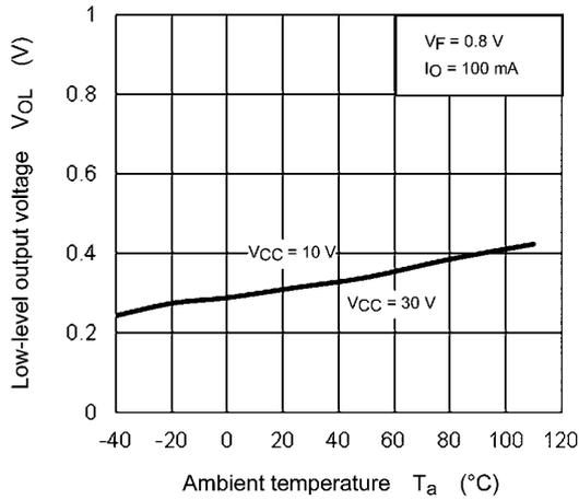
Fig. 13.2.7  $V_{OL} - T_a$
