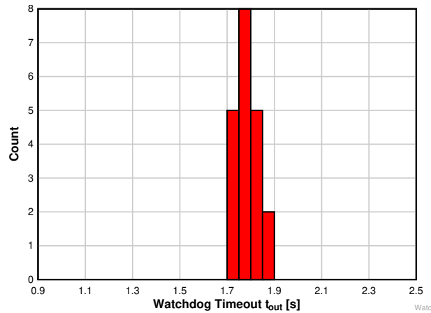
图 6-14. TPS3823A-33 器件在 125°C 时的看门狗超时直方图 (单位数 = 20)
