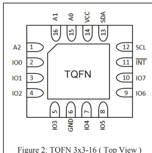
Figure 2: TQFN 3x3-16 ( Top View )
